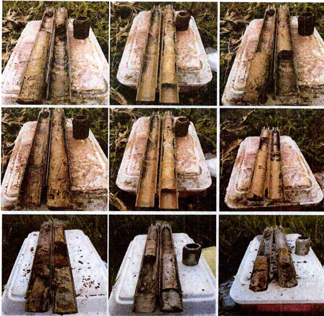
Fotografía 1. Muestras con alto contenido de agua recuperadas con el ensayo SPT.
