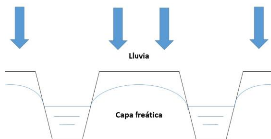
Figura 16. Sistema de drenaje superficial por zanjias abiertas
