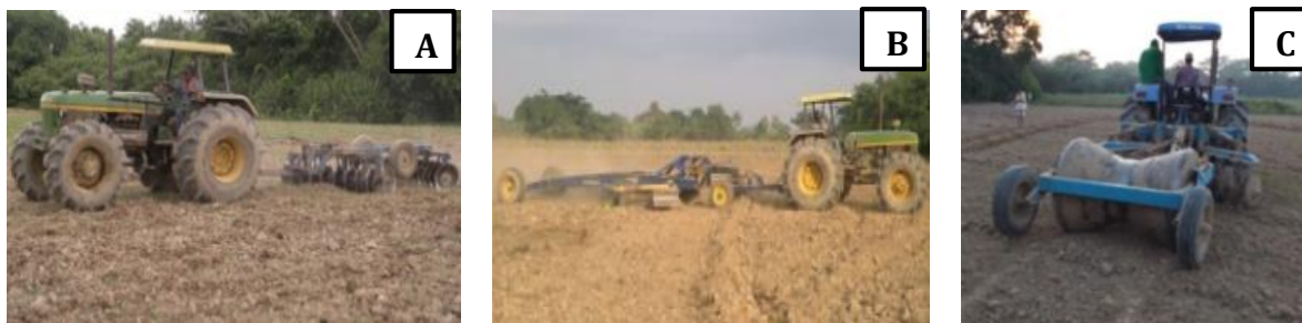
Figura 9. Implementos utilizados en parcela de integración de ñame espinoso en Majagual. A. Rome. B. Land plane. C. Taipa.
